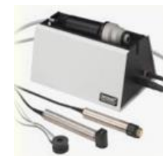
Dermalabを利用した水分損失量測定
