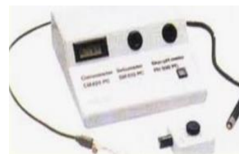
Corneometerを利用した水分含有量測定
